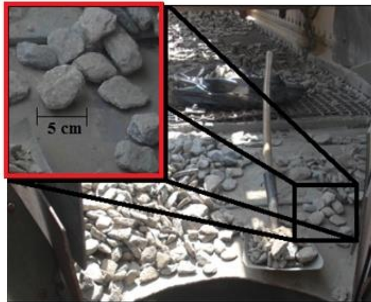
Figura N°42. Desgaste del material causado por los paños de las cribas
