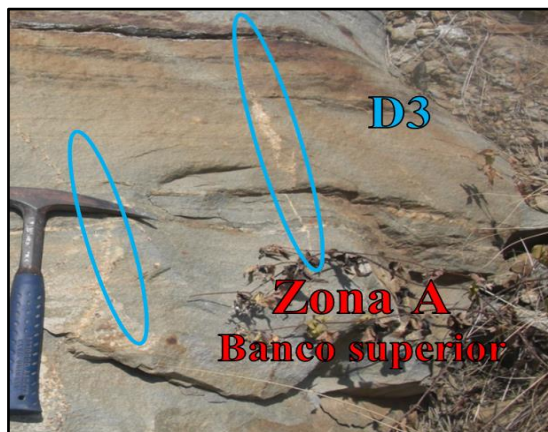
Figura N°32. Relleno de alguno de los planos de diaclasa D3 no expuestos del macizo rocoso de la cantera “Carayaca”
