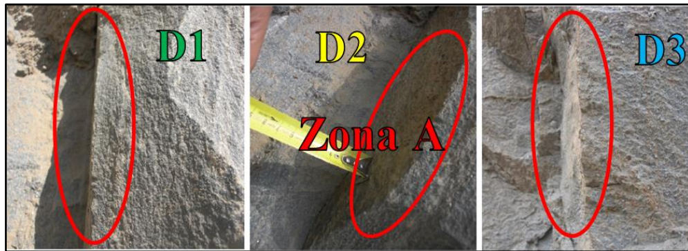
Figura N°31. Rugosidad en las discontinuidades del macizo rocoso de la cantera “Carayaca”
