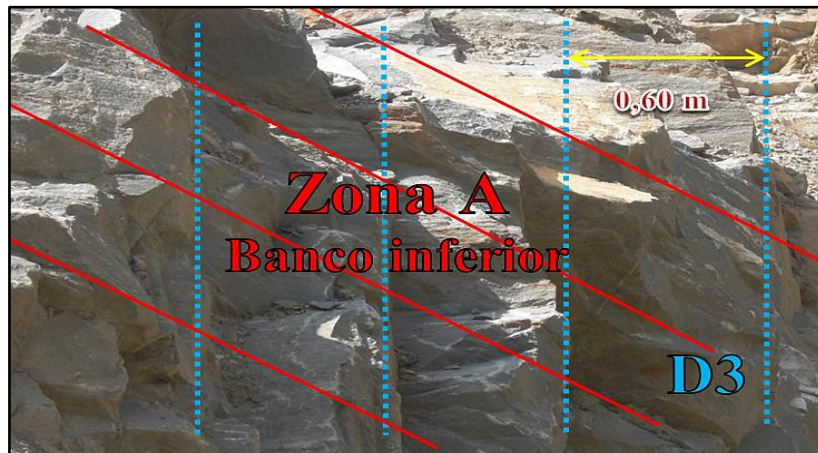
Figura N°29. Familia de diaclasas D3 (color azul) y planos de foliación (color rojo) del macizo rocoso de la cantera “Carayaca”
