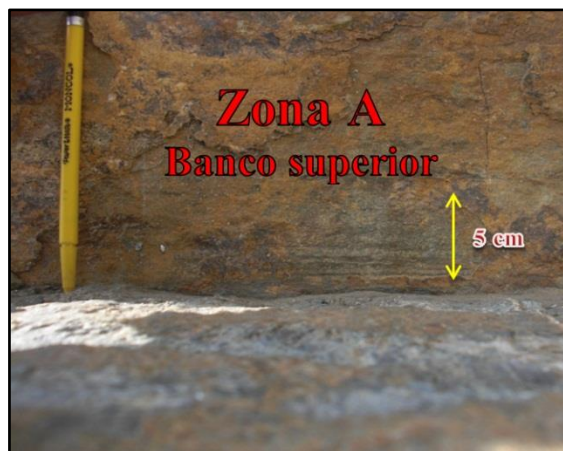
Figura N°33. Alteración de las discontinuidades de la Zona “A” del macizo rocoso de la cantera “Carayaca”
