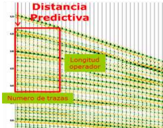
Figura 3.7. Imagen representativa de un Disparo en común, para representar como determinar los parámetros del SWD.
