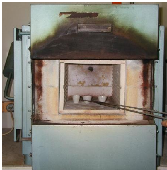
Fig 8. Mufla de Cerámica bajo atmósfera de aire estático
