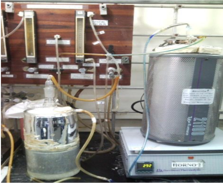
Unidad de hidrot ratamiento de tiofeno
