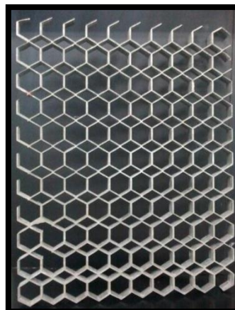
Figura 24. Panel alveolar construido en acero inoxidable
