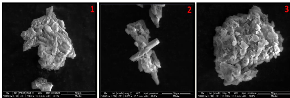
Figura 59. MEB de \text{Na}_2\text{CO}_3 \cdot \text{H}_2\text{O} obtenidas a 40 °C
