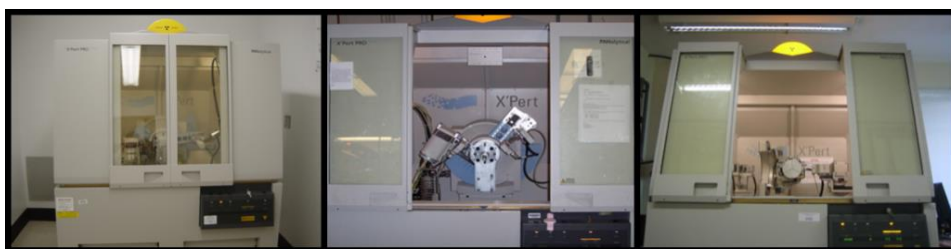
Figura 44. Equipo de difracción de rayos X, X'Pert Pro de PANalytical
