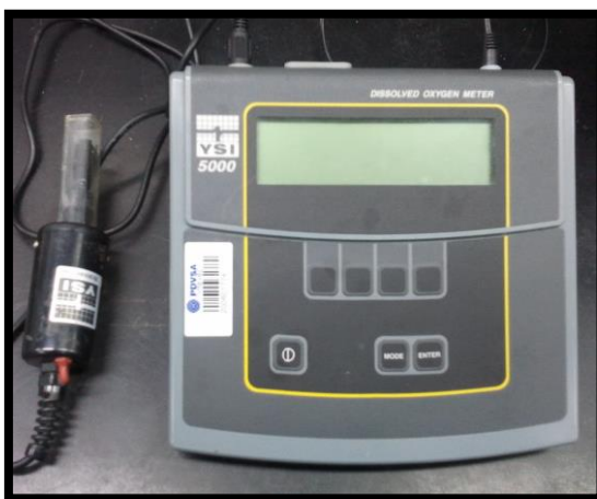
Figura 42. Medidor de oxígeno disuelto, Modelo YSI 5000
