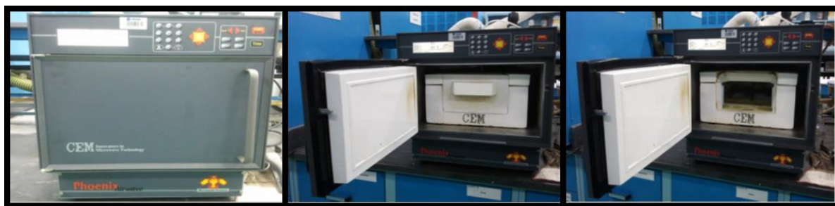
Figura 17. Horno microondas para la evaporación del licor cáustico marca Microware Muffle Furnace, modelo Phoenix
