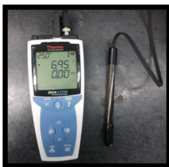
Figura 14. pH-metro Thermo Electron Corporation, modelo Orion 4 STAR
