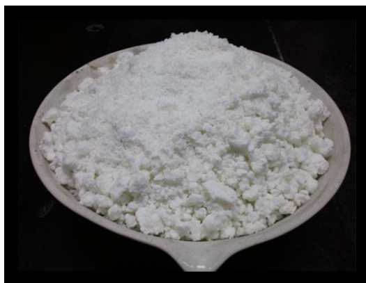
Figura 90. \text{Na}_2\text{CO}_3 \cdot 1.5\text{H}_2\text{O}_2 sintetizado de las sales obtenidas de la evaporación
