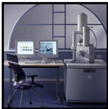
Figura 45. Microscopio electrónico de barrido FEI, QUANTA FEG 250
