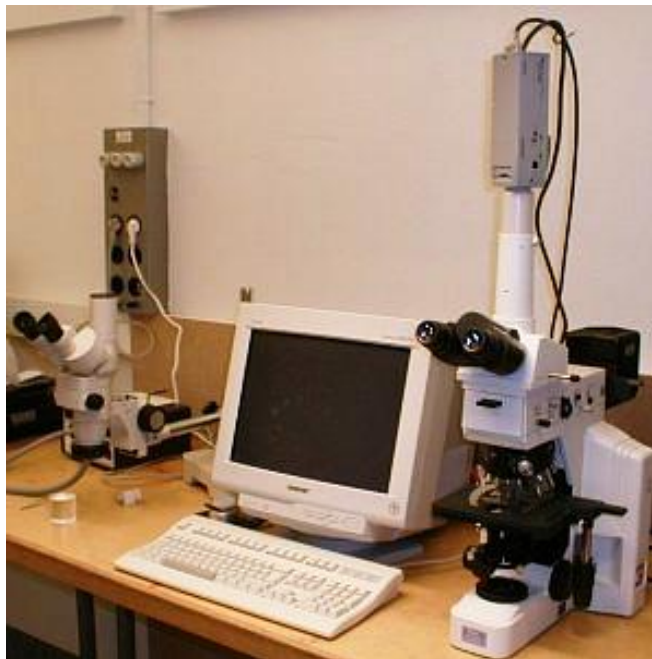
Figura N°8: Microscopio Nikon Eclipse ME600 (EPI) con Cámara CCD.
