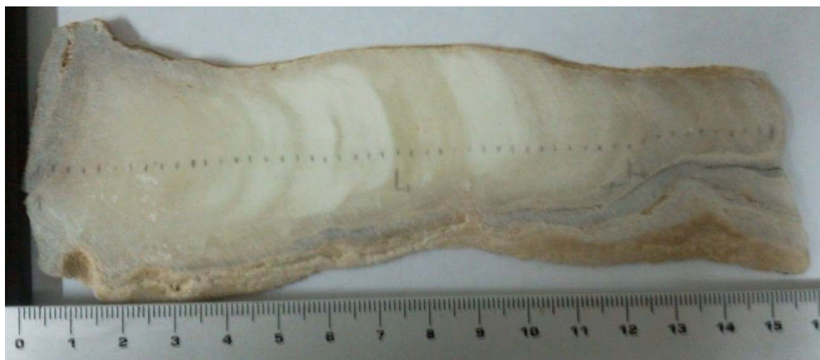
Fig 38. Imagen de la sección inferior de la muestra FMCG-2 luego de analizada donde observamos los 51 puntos de donde se colectaron 812 espectros en total.
