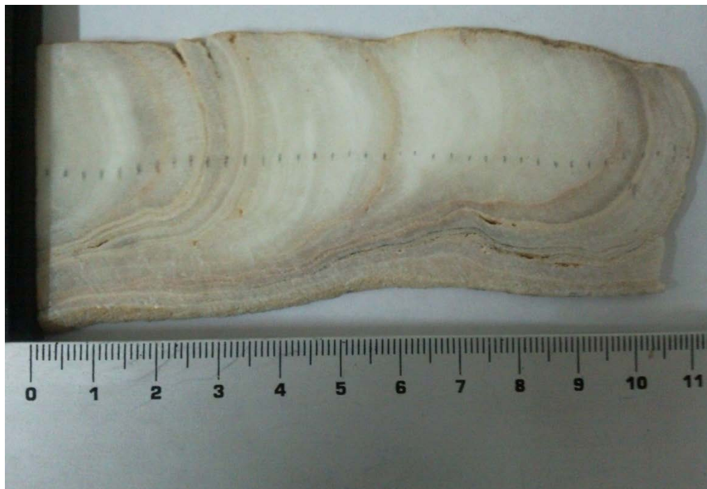
Fig 39. Imagen de la sección del medio de la muestra FMCG-2 luego de analizada donde observamos los 38 puntos de donde se colectaron 576 espectros en total.
