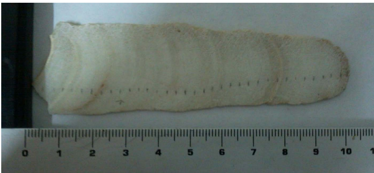
Fig 40. Imagen de la sección superior de la muestra FMCG-2 luego de analizada donde observamos los 34 puntos de donde se colectaron 495 espectros en total.
