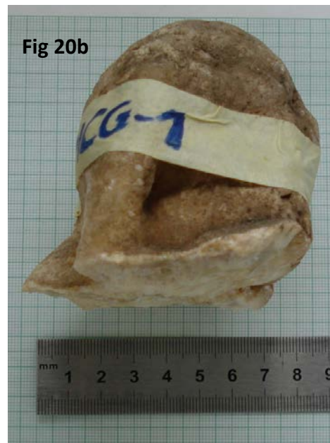
Fig 20. Medidas de la muestra FMCG-1.
