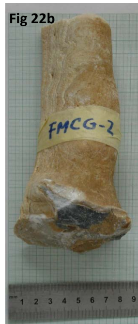
Fig 22. Medidas del fragmento inferior de la muestra FMCG-2
