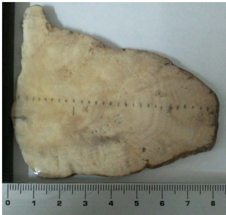
Fig 37. Imagen de la muestra FMCG-1 luego de analizada donde observamos los 27 puntos de donde se colectaron 406 espectros en total.
