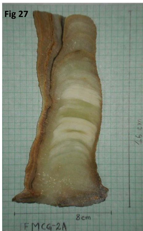
Fig 27. Corte del fragmento FMCG-2A, donde podemos la presencia de bandeamientos como resultado de su proceso de formación en las regiones externas de la muestra. En el tope superior el extremo cóncavo producto del hiato.
