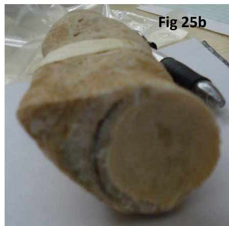
Fig 25. En la fig 25a podemos observar que la forma de la muestra FMCG-2 no es totalmente recta, con desviaciones en su crecimiento hacia la mitad de la misma y en la 25b podemos observar el extremo convexo como consecuencia del posible hiato y algunas bandas más oscuras en las zonas externas de éste.
