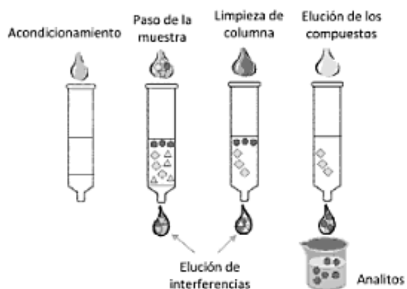
Figura 7. Esquema de preparación de muestra mediante SPE [37] .
