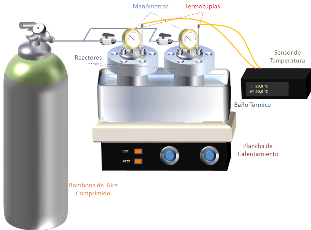
Figura N° 24. Esquema del sistema experimental de bioconversión de crudos pesados.
