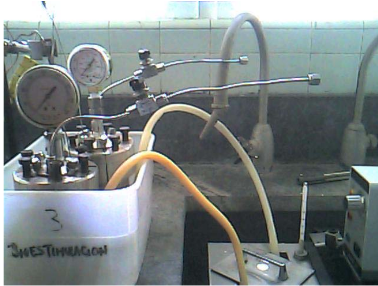
Figura N° 26. Sistema de bioconversión utilizado para el proceso, con el baño térmico y los reactores parr.
