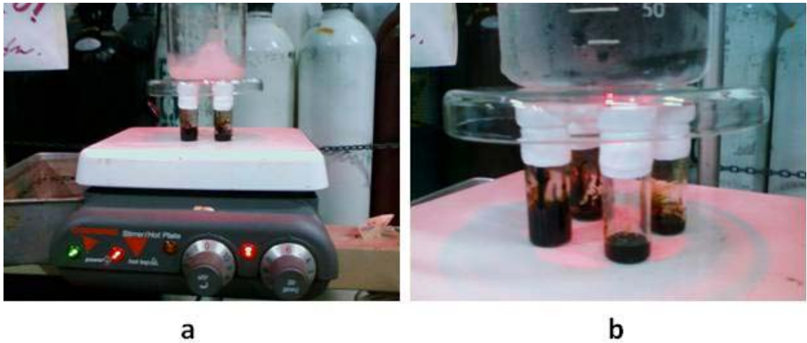
Figura Nº 29. Sistema usado para el craqueo térmico. a) Vista del sistema completo. b) Acercamiento de los viales con muestras.
