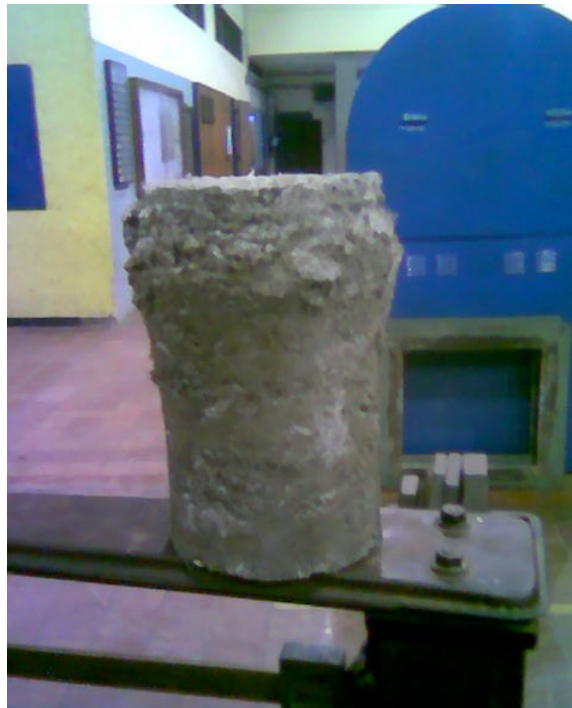
Figura 14. Falla por aplastamiento mezcla con 2% de fibra
