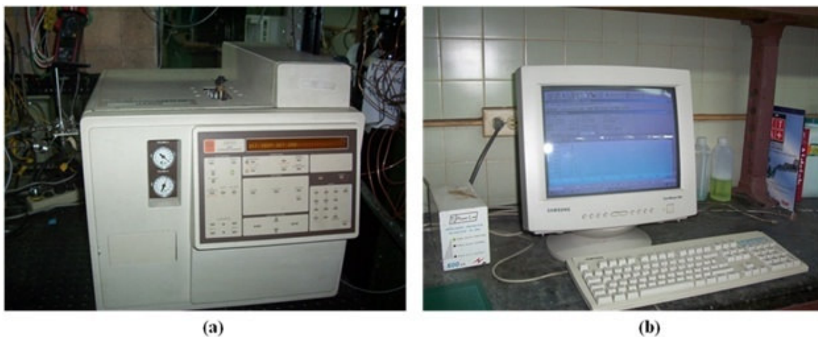
Figura N° 18. Sistema de análisis. (a) Cromatógrafo Varian 3300. (b) Procesador.
