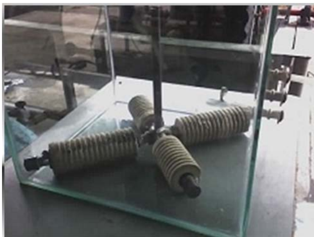
Figura 8: Sistema de aireación.
