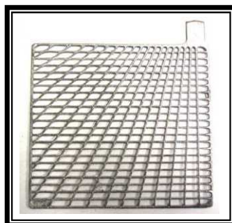
Figura N° 4. Tipo de rejilla de Batería Plomo-Ácido. (Hegner, 1986).
