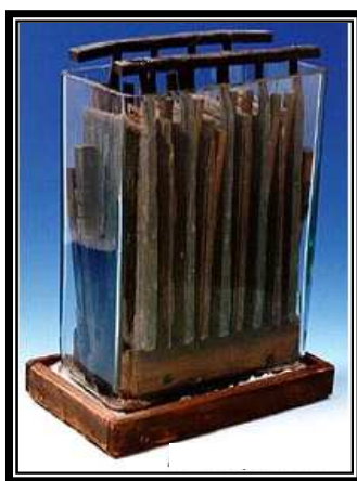
Figura N° 2. Primera pila recargable inventada por Planté en 1859. (Bode, 1986)
