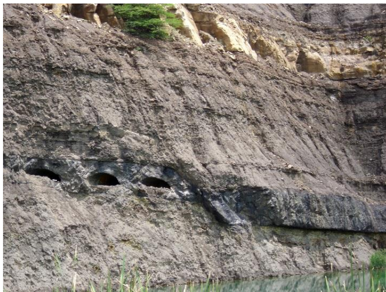
Figura 12. Capa de carbón fallada en la mina.
