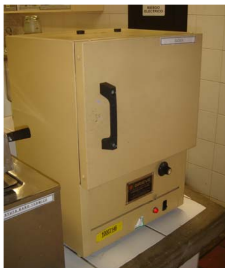
Figura A-10. Estufa empleada para la determinación de Sólidos Totales y Grasas.
