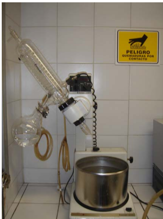
Figura A-14. Rota evaporador empleado para la determinación de aceites y grasas.
