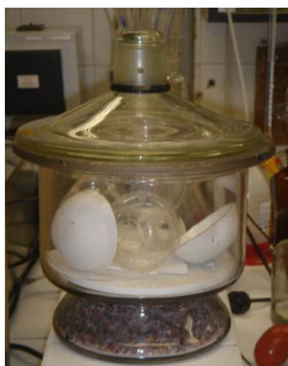
Figura A-11. Desecador empleado para la determinación de Sólidos Totales y Grasas.
