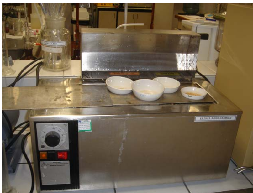
Figura A-13. Estufa Baño Térmico empleado para la determinación de Sólidos Totales
