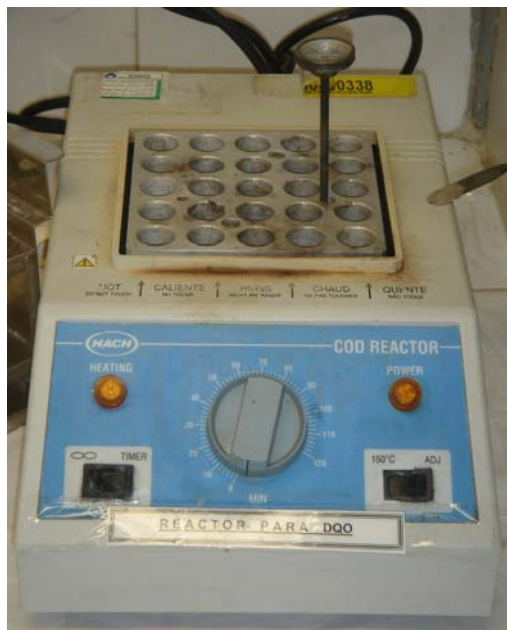
Figura A-6. Reactor empleado para la determinación de DQO.
