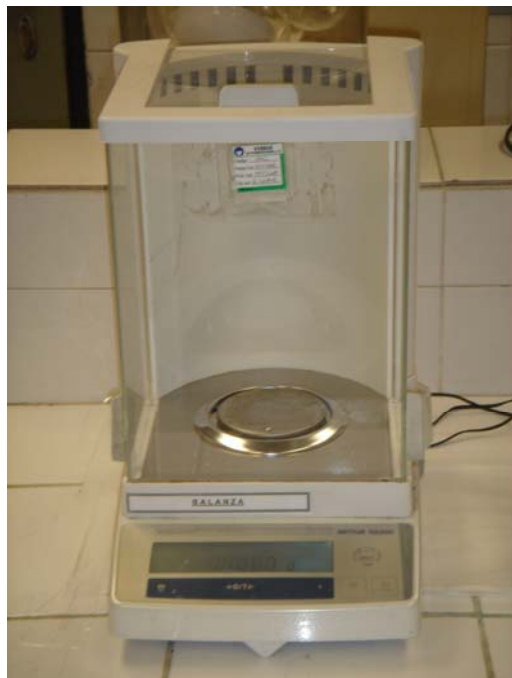
Figura A-12. Balanza analítica empleada para la determinación de Sólidos Totales y Grasas.
