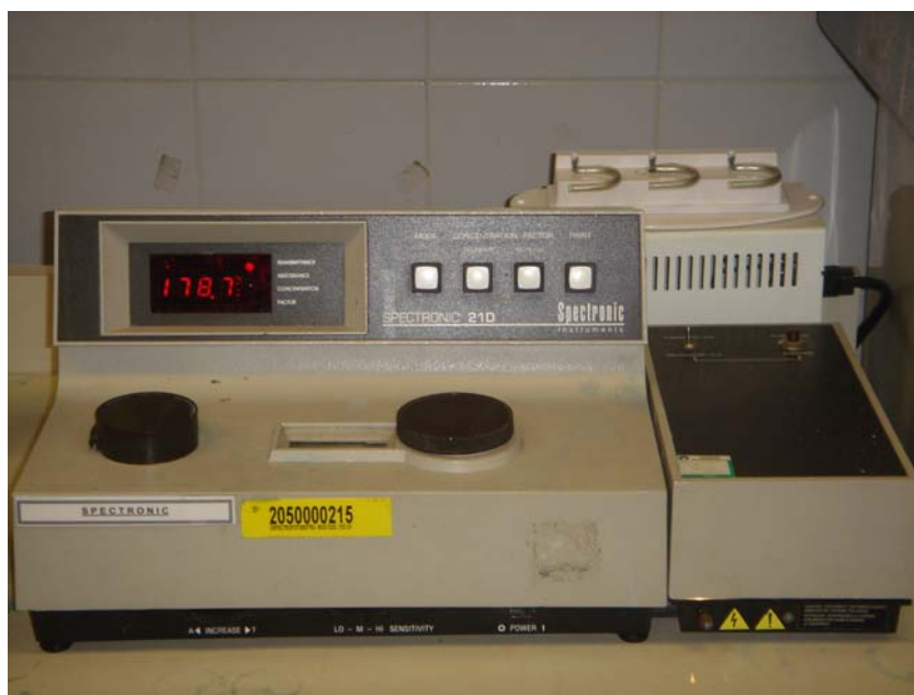
Figura A-7. Espectrómetro empleado para realizar las lecturas de DQO.
