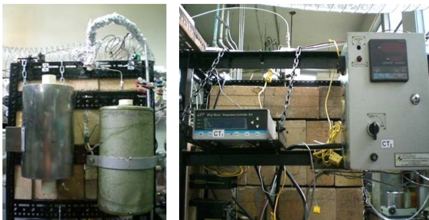
Figura N° 14. Sección de reacción. (a) Hornos. (b) Controladores de temperatura
