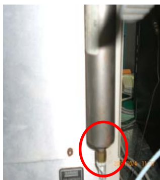
Figura N° 48. Conexión de gas de arrastre en el cromatógrafo
