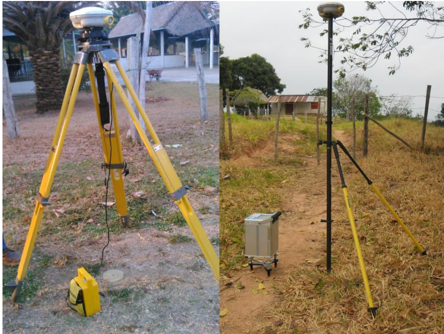
Figura 4.4. Posición de equipos geodésicos y gravímetro, durante la adquisición del Perfil Andes Sur.
