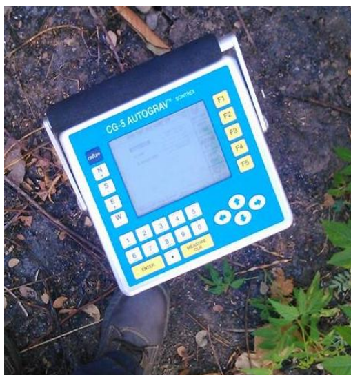
Figura 4.1. Gravímetro CG-5 Scintrex Autograv System, utilizado para levantamiento del Perfil Andes Sur (GIAME).
