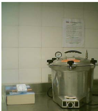
Figura N° 16: Autoclave utilizada para esterilizar material de laboratorio
