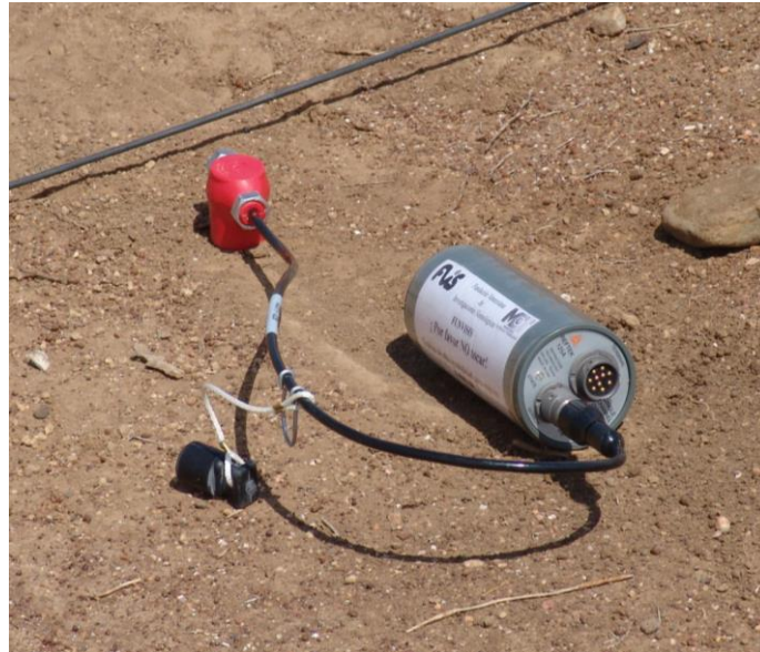
Figura 5. Grabador sísmico portátil tipo Texan marca Reftek modelo 125A-01
