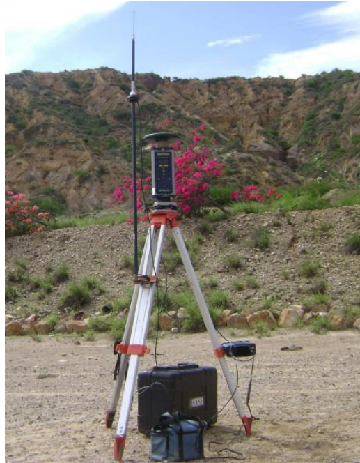
Figura 6. Sistema Global de Navegación Satelital Marca Magellan Thales modelo Z-Max.Net utilizado para el posicionamiento de los datos sísmicos.
