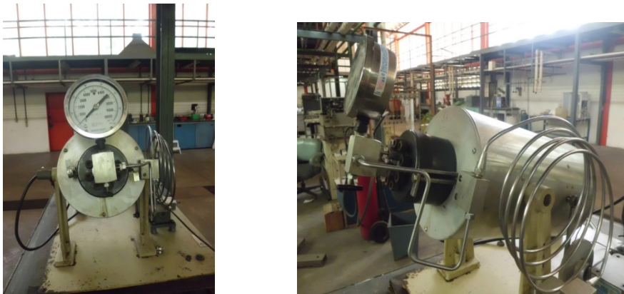
Figura 5. Reactor Parr (vista frontal y vista lateral).
