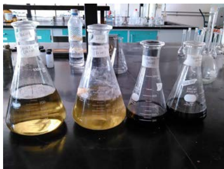
Figura 7. Líquidos resultantes de la digestión ácida.
