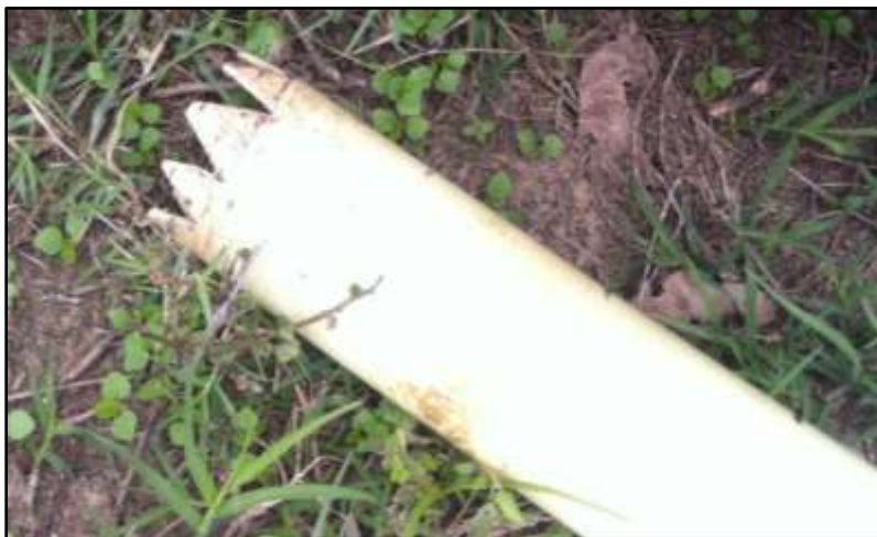
Figura 8. Tubo de PVC empleado para la toma de muestras de suelos.
