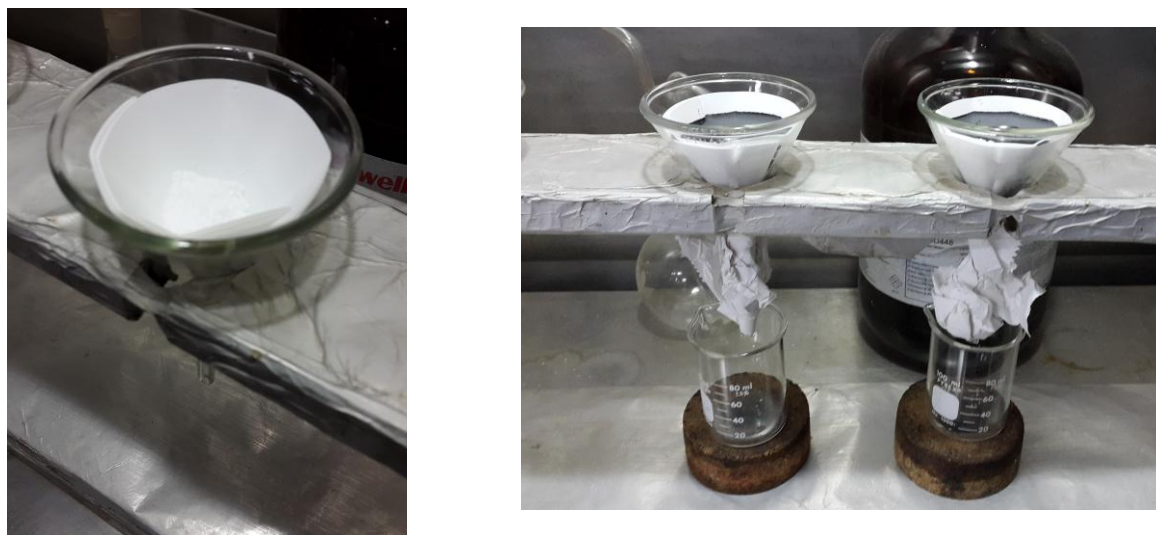
Figura 12. Montaje para filtrar crudo deshidratado por gravedad.
