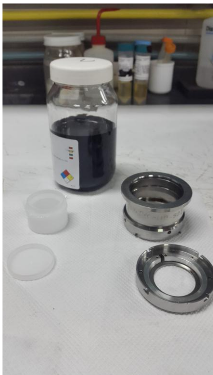
Figura 19. Envase de plástico y portamuestra que es llevado al equipo para el análisis de la muestra.
