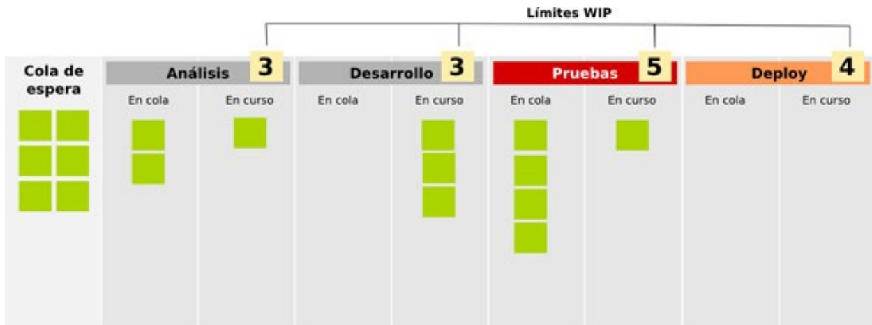
Figura 5. Ejemplo de Tablero Kanban que muestra un cuello de botella producido en la columna de “pruebas” pues el límite WIP está cubierto, mientras que el proceso siguiente (deploy), está totalmente libre. [7]
