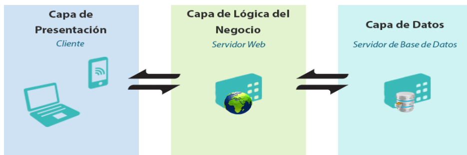
Figura 2: Arquitectura de Tres Capas para comercio electrónico. Fuente: Autores (2016).
