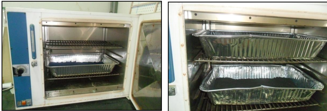
Figura 3.9. Bandejas con las arenas ya teñidas en el horno para su secado.
