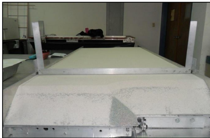
Figura 3.14. El rizador juega un papel fundamental en la construcción de las capas.
