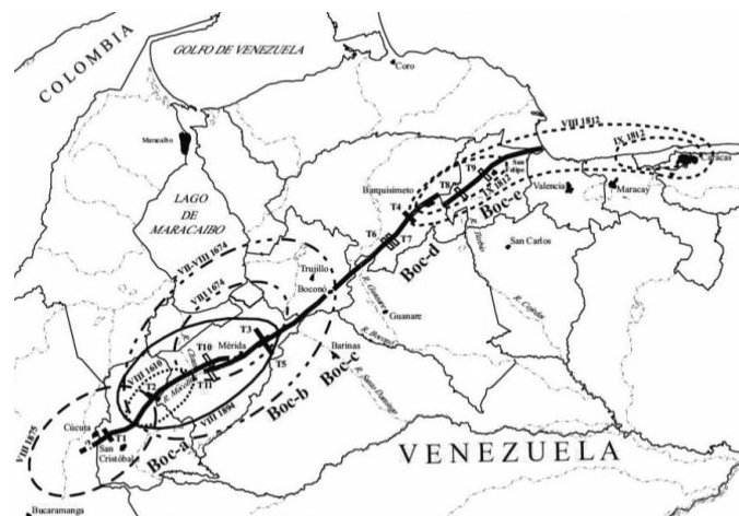
Figura 2.22. Segmentación de la falla de Boconó (Tomado de Audermard, 2014).
