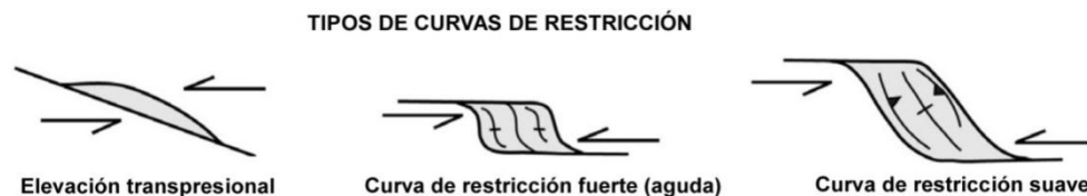
Figura 2.7. Tipos de curvas de restricción o inflexiones en cierre (Tomado y modificado de Mann 2007)
