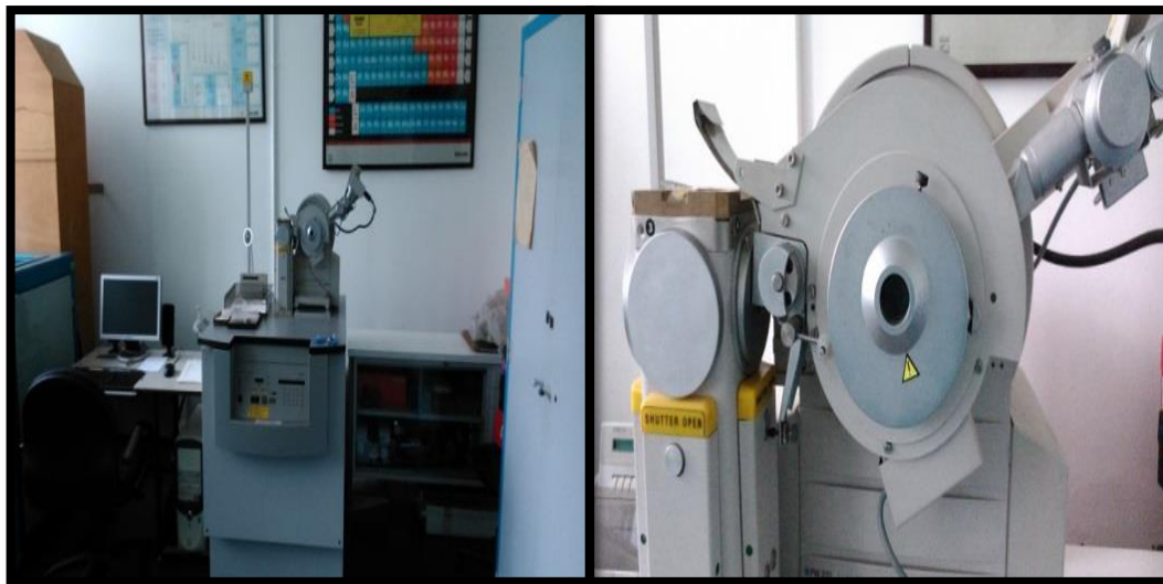
Figura 7. Equipo de difracción de rayos X, Laboratorio de difracción rayos X, Departamento de Geología, UCV.
