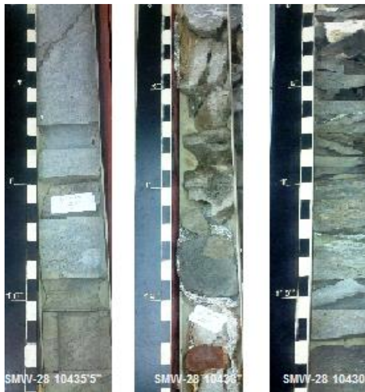
Figura 36. Arenisca Dolomítica Micrítica (10435'5'' Levemente bioturbada con fracturas rellenas de material lodoso y calcáreo), Dolomía Aloquímica Arenosa (10433' Se observa un nódulo de óxido, así como material calcáreo y fósiles retrabajados), Caliza Aloquímica (10430' se observan granos de fosfatos con fósiles medianamente preservados).
