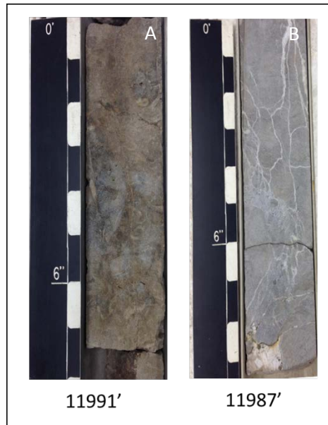
Figura 29 - Vetas cementadas de grandes tamaños en la Caliza O, A: caliza más arenosa hacia la base con restos de conchas fósiles; B: caliza con estructuras nodulares de calcita y fracturas cementadas.
