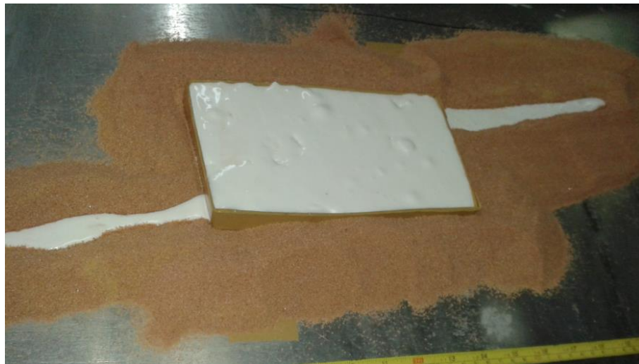
Figura 3.7 Fotografía del arreglo de la primera capa del modelo M1, compuesta por flubber y arena 20/40.
