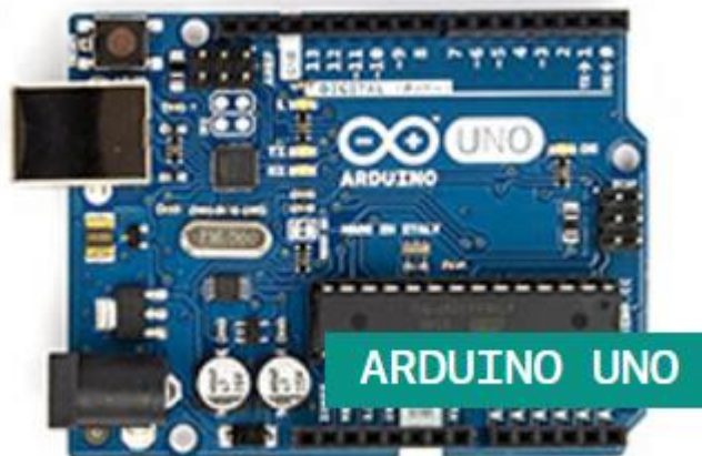
Figura 2.1 Tarjeta Arduino Uno (Tomado de www.arduino.cc ).
