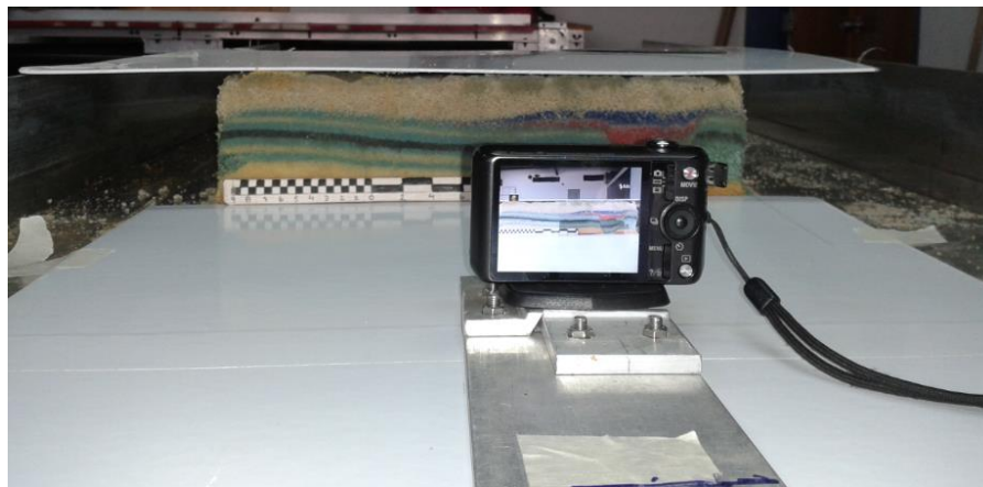
Figura 3.16 Fotografía de la disposición de la cámara frente al modelo.
