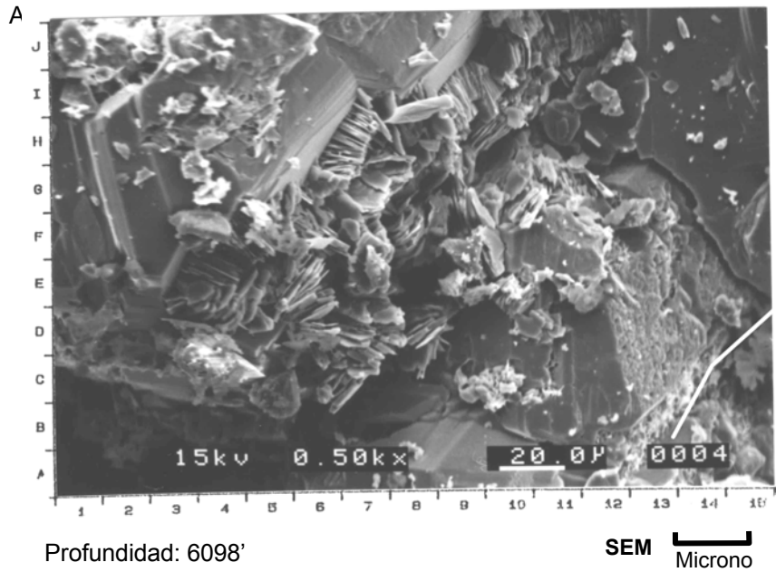
Muestras 6098'. Fotomicrografía de S.E.M, magnificación: X500. Caolinita relleno poros intergranular (G6) sobre el sobrecrecimiento de cuarzo (G2).
