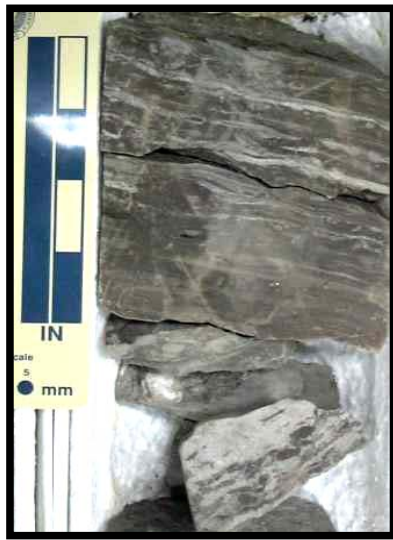
Foto 3.16. Núcleo del pozo PB-694, profundidad 5900' Estratificación ondulada.
