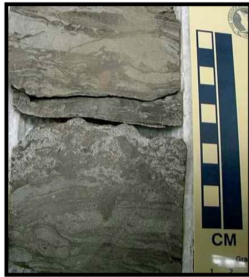
Foto 3.17. Núcleo del pozo PB-694, profundidad 5903', Aumento en el contenido de arenas hacia la base de la subfacies 1a.
