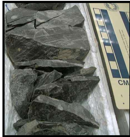
Foto 3.19. Núcleo del pozo PB-694, profundidad 5911', Delgadas intercalaciones y lentes de areniscas produciendo la estratificación lenticular.
