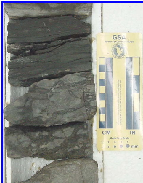
Foto 5.2. Pozo CC-2A, miembro B-4 de la Formación Misosa. Intervalo que se presenta heterolítico hacia la base y el tope y lutítico en la parte media. Precisamente en el intervalo lutítico se aprecia estratificación planar ondulada. (profundidad 3873'-3874'42").
