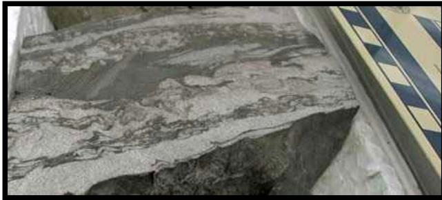
Foto 3.18. Núcleo del pozo PB-694, profundidad 5925', Alto grado de bioturbación de la subfacies 1a.
