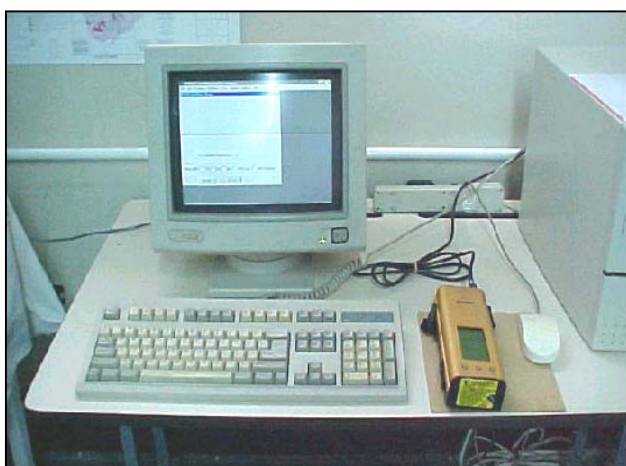
Fig. 4.8. Equipo Niton XL-722S conectado a una computadora mediante una interfase
