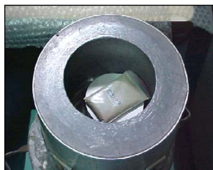
Fig. 4.12. Detalle de una muestra dentro del cilindro de plomo del espectrómetro gamma.
