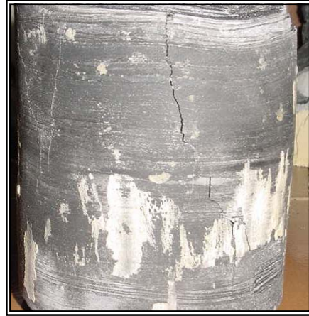
Fig. 50 Detalle de la falla del cilindro Mi G
