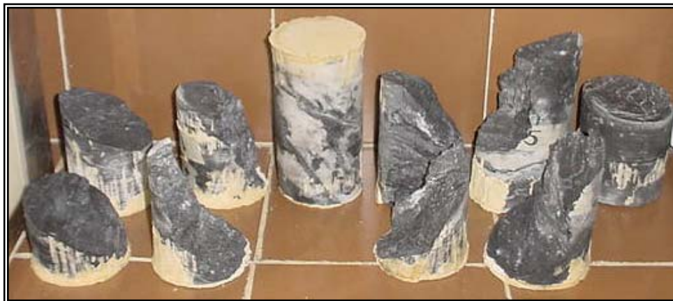
Fig. 48 Estado de los cilindros de roca muestreados después del ensayo
