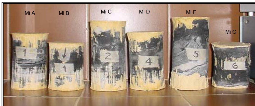
Fig. 47. Estado de los cilindros de roca muestreados antes del ensayo
