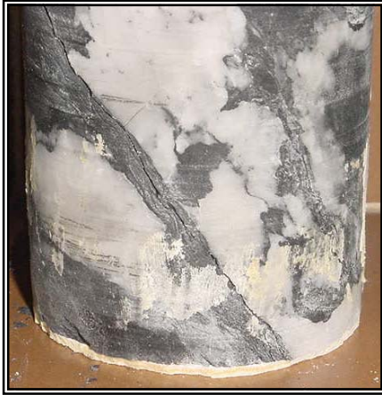
Fig. 49 Detalle de la falla del cilindro Mi C
