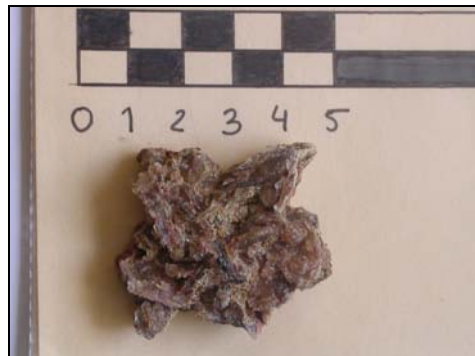
Fig. 19 Presencia de yeso precipitado en forma de vetas característico de la unidad B. Formación El Veral. Medidas en cm.
