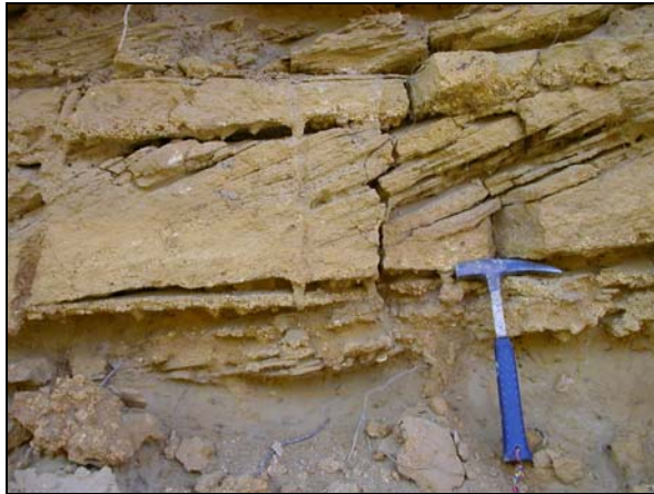
Fig. 30. Estratificación cruzada en arenisca de la unidad t2. Formación Tucupido
