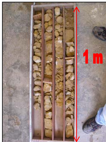
Fig. 28. Paquete de 4 metros de arenisca característico de la unidad t1. Formación Tucupido
