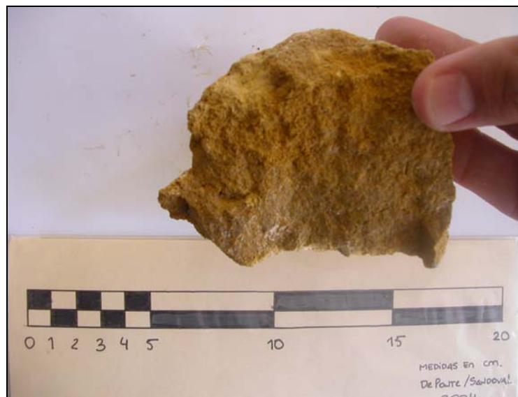
Fig. 29. Arenisca muy meteorizada, de color ocre característica de la unidad t2. Formación Tucupido
