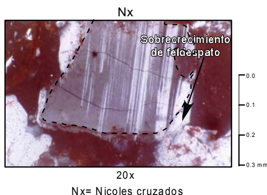
Fotomicrografía 6.4. Sobrecrecimiento de feldspatos en continuidad óptica en una arenisca arcósica perteneciente al pozo MCH 3-2X, profundidad: 6052',1''.
