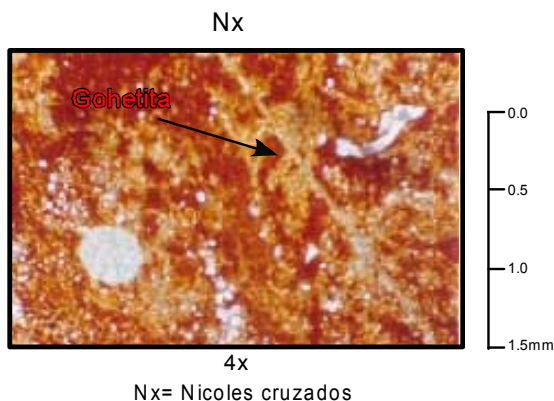
Fotomicrografía 6.5. Intensa cementación de óxidos de hierro (Goetita), la cual se encuentra enmascarando la matriz. Arcilita en el pozo MCH 6-4X, profundidad: 3452.
