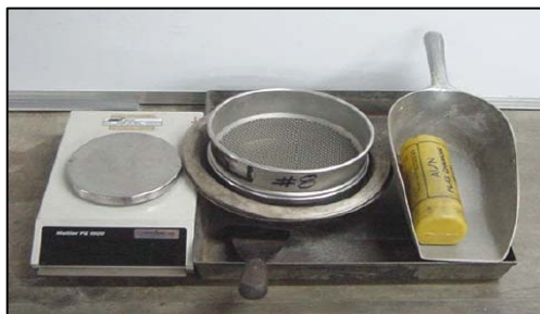
Figura 5: Equipos requeridos para ensayo de peso específico y absorción
