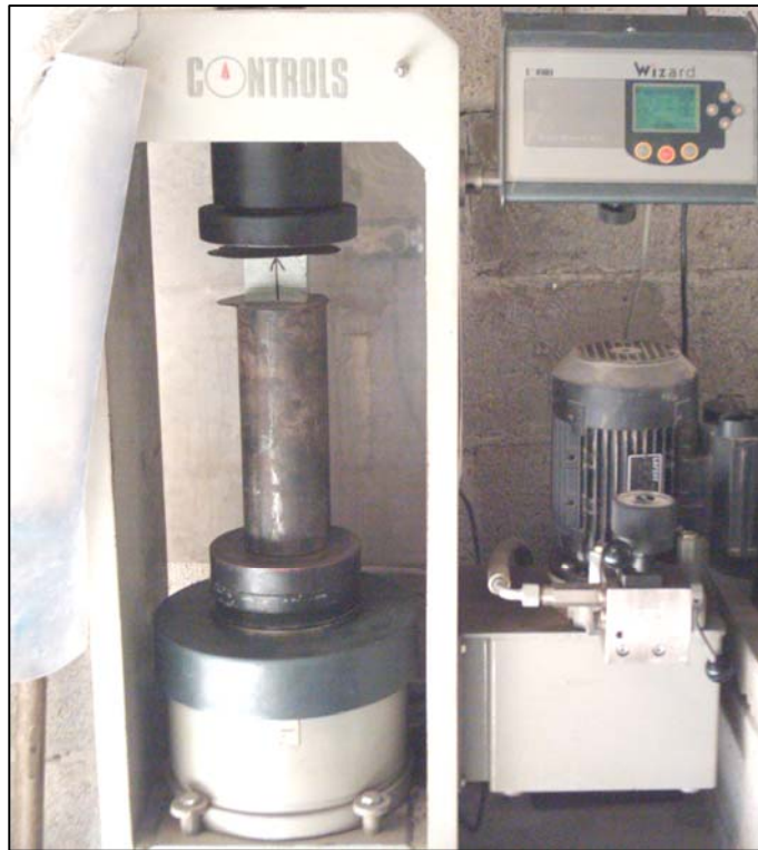
Figura 12: Ensayo de resistencia a la compresión simple.
