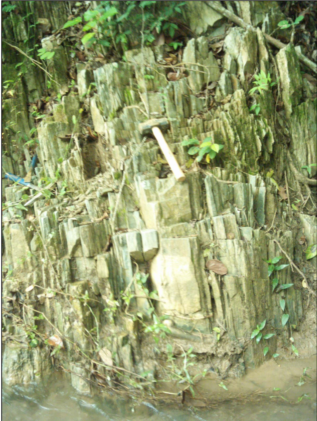
Figura 109: Diaclasado presente en la quebrada Charallave. Foto tomada con rumbo N70°E.
