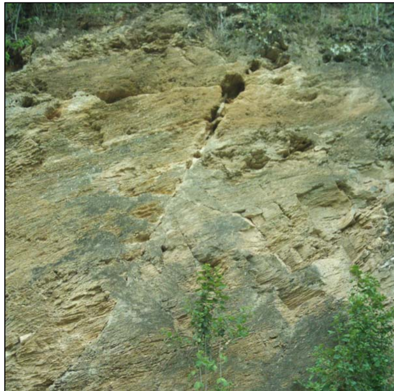
Figura 86: Detalle de la falla vista en la localidad de La Chivera. Rumbo N80°E
