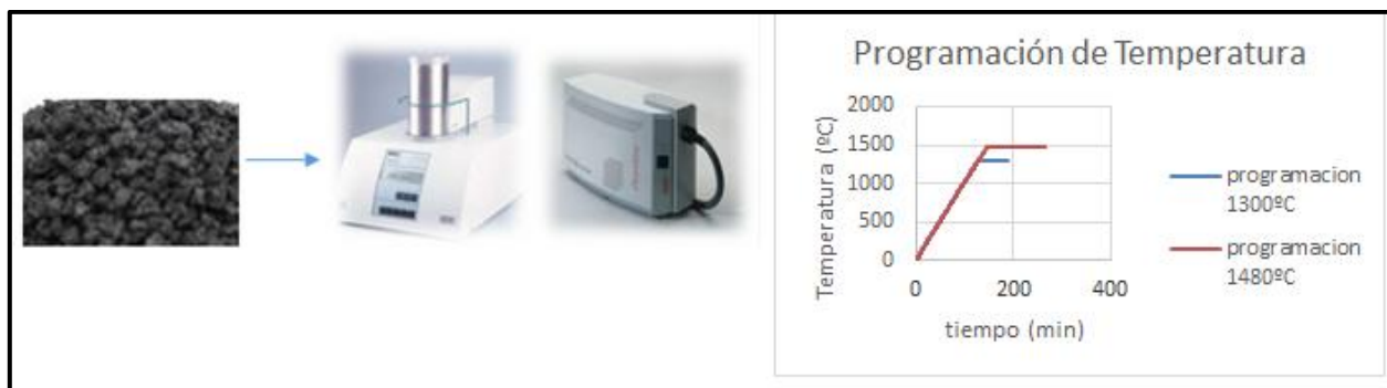
Figura 14: Tratamiento térmico del coque de petróleo
