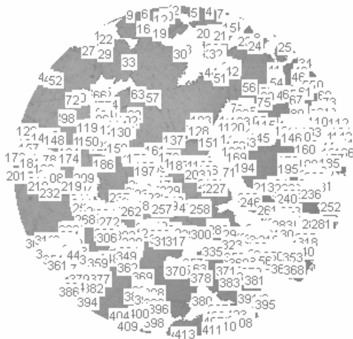
Figura 57. Imagen binarizada y analizada por el programa Scion Image de una de las fotografías de la figura 56 que cubren la sección fina de la Muestra 1. VLG-3727 Profundidad: 15262'-15264'
