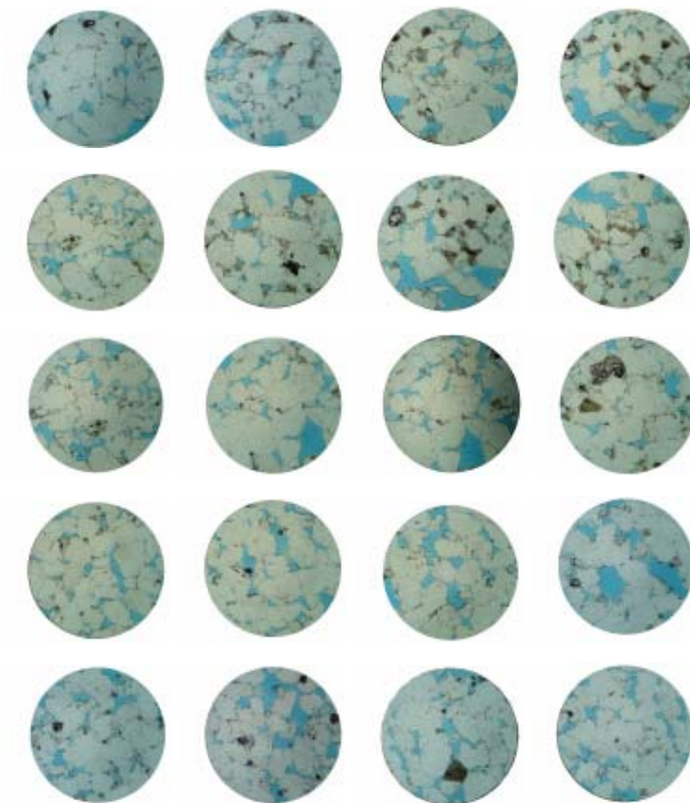
Figura 56. Collage de 20 fotografías que cubren la sección fina de la Muestra 1. VLG-3727 Profundidad: 15262'-15264' Objetivo 10x/0.30, con nícoles paralelos y ocular 10x/20.
