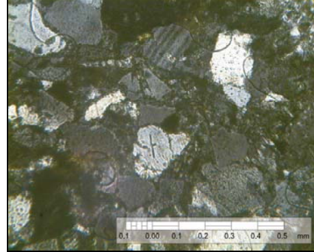
Figura 19. Fotomicrografía (NC) de la sección fina PO2-A objetivo 10X. Se observan fragmentos de roca y feldespatos
