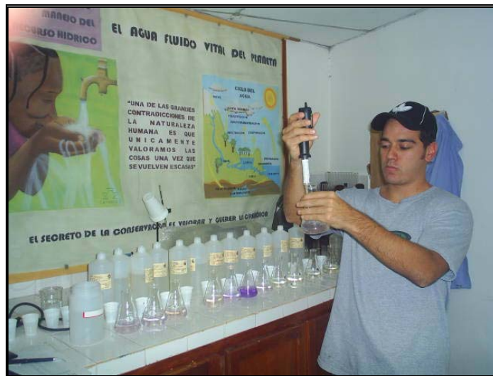
Titulación para obtener concentraciones de Cloruros. Fig. 1.15
