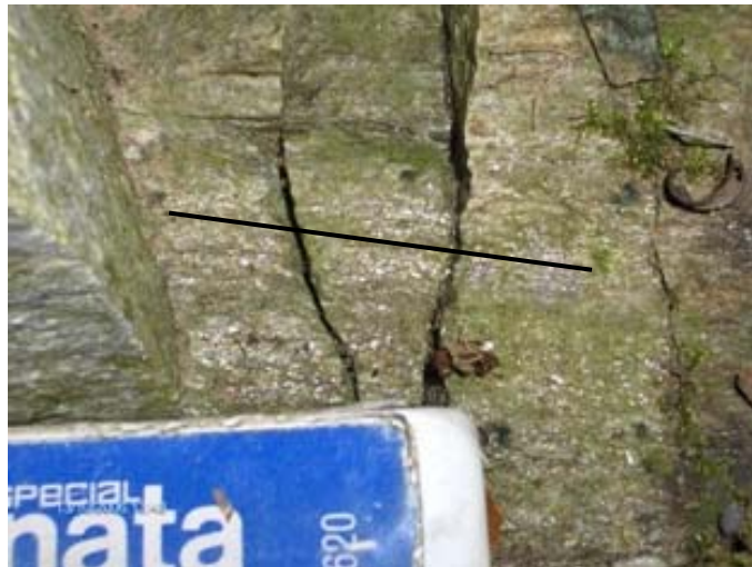
Fig. 82. Foliación laminar en los esquistos cuarzo-feldespático-micáceo, definida principalmente por los minerales filosilicatos. Fa-44.
