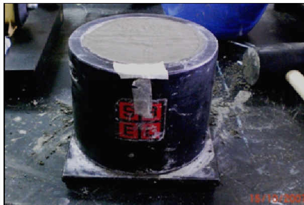
Foto 14. Muestra montada totalmente recubierta por concreto. Foto: Luis Zurbarán
