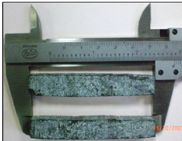
Foto 11. Muestra para realizar ensayo de corte directo, muestra de 1x1x5 cm, muestra de roca homogénea. Foto: Luis Zurbarán.
