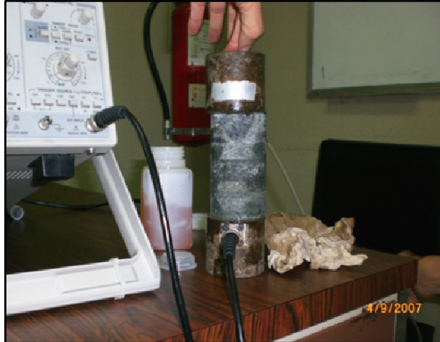
Foto 15. Ensayo de determinación de constantes elásticas por pulsos sónicos, Muestra del túnel San Juan. Foto: Luis Zurbarán
