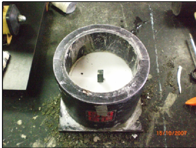
Foto13. Muestra de roca montada en forma vertical en el molde completo y con un separador circular de anime. Foto: Luis Zurbarán
