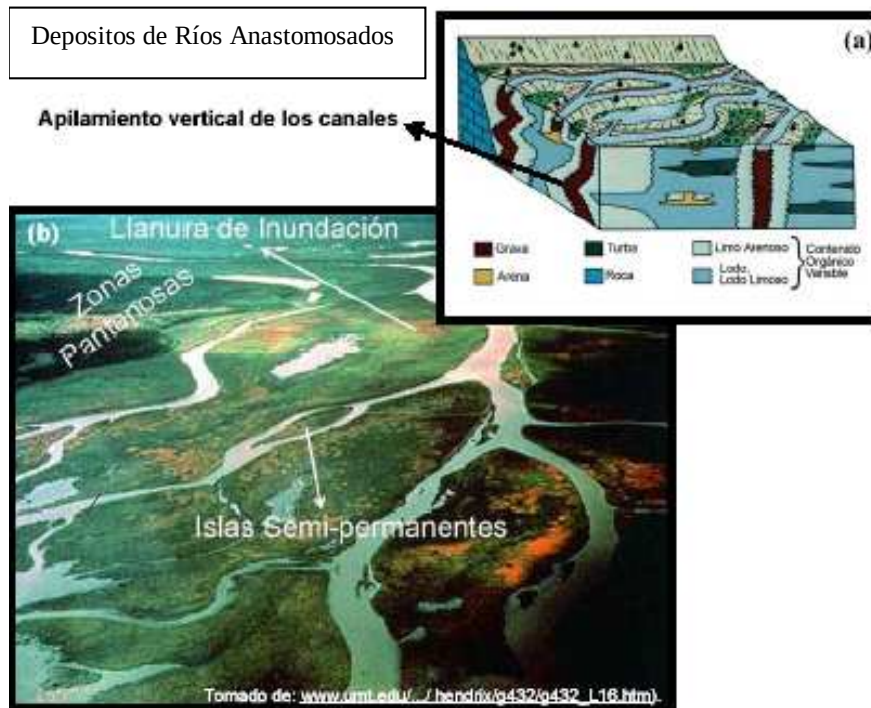
Figura 2.11: Sistema fluvial anastomosado. (a) Bloque diagramático, se muestra el apilamiento vertical (Modificado de CANT, 1982). (b) Sistema anastomosado al sureste de Saskatchewan, Alaska Tomado y modificado de: University of Montana, Department of Geology ,2005.)
