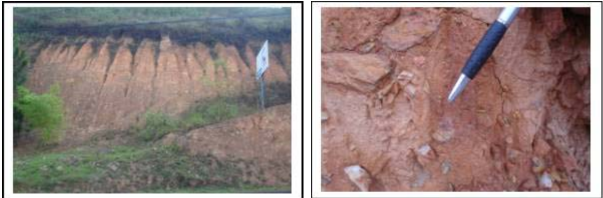
Foto 16. Talud 14. Metaareniscas suelo residual (izquierda). Detalle de fragmentos de cuarzo
