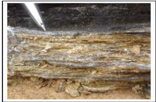
Foto 7. Talud 21. Esquisto-cuarzo-micáceo-feldespático (izquierda). Muestra de mano, se aprecia foliación de los estratos (derecha).
