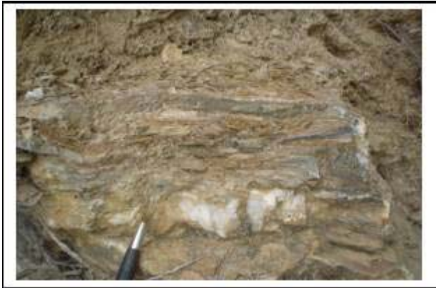
Foto 8. Talud 20. Esquisto-cuarzo-micáceo-feldespático (derecha). Muestra de mano, se aprecia foliación de los estratos y micas cloríticas (izquierda).
