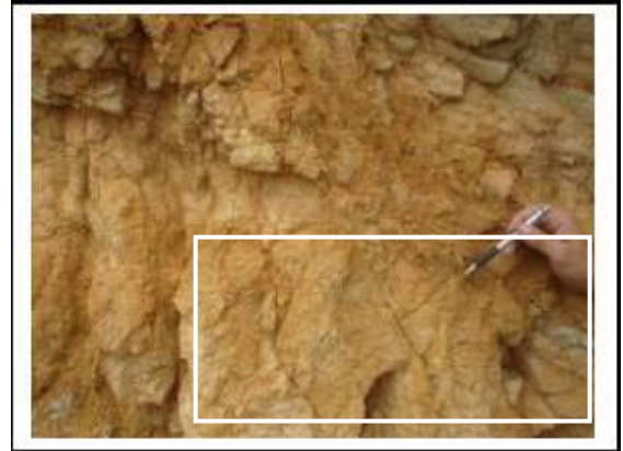
Foto 11. Talud 13. Metaconglomerado (izquierda). Detalle, granos de cuarzo sin orientación preferencial, familia de diaclasas en el rectángulo (derecha).
