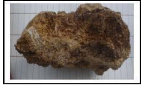
Foto 4. Talud 24. Metaconglomerados (izquierda). Muestra de mano, se aprecia fragmentos de cuarzo (derecha).
