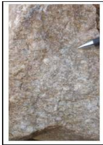
Foto 6. Talud 22. Metaconglomerados (izquierda). Muestra de mano, se aprecia fragmentos de cuarzo y micas cloritas y muscovitas (derecha).
