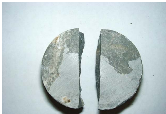
Figura 2.29. Fractura Típica de Ensayo de Tracción Indirecta. Foto: FUENMAYOR (2001).
