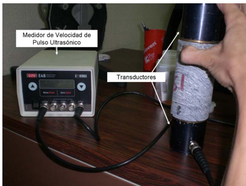
Figura 2.22. Equipos usados en el ensayo para la obtención de la velocidad de Onda P en roca. Medidor de pulso ultrasónico UPV-E48. Foto: ALVAREZ, (2007).
