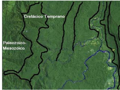
Figura 7-23. Figura que muestra en composición RGB752 la sección de la imagen donde se encuentra el contacto propuesto, marcado en líneas negras, entre las unidades de edad Paleozoico-Mesozoico sin diferenciar y Cretácico Temprano, donde se puede apreciar la diferencia visual y textural entre ambas unidades. La sección de la imagen se muestra a escala 1:300.000.
