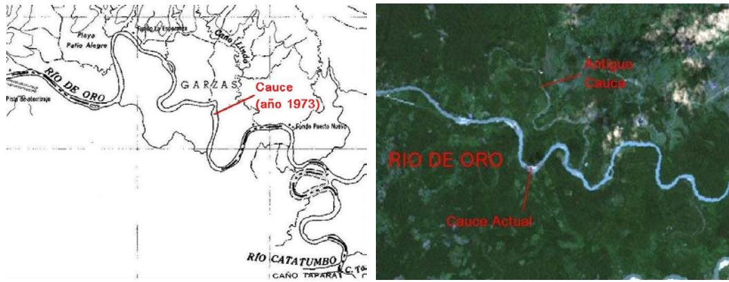
Figura 7-27. Figura que muestra el cambio de curso en una sección de Río de Oro. A la izquierda se observa la posición del cauce para el año 1973 (carta topográfica) y a la derecha el cauce actual en la imagen satelital.
