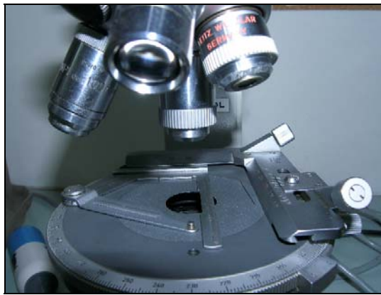
Fig. 3. Microscopio Petrográfico Leitz H-pol con platina de vernier ajustable.
