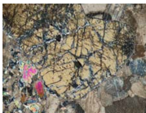
Fig. C376. Obsérvese el cristal de piroxeno (diópsido).
