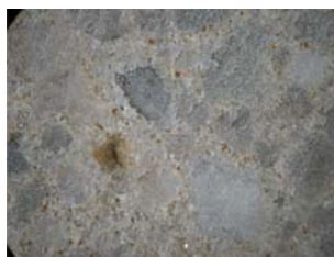
Fig. B3. Nótese el mal escogimiento de la arenisca.
