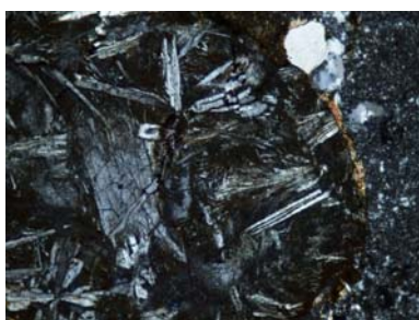
Fig. 31. Clasto de fenoandesita con textura glomeroporfídica (La-1520-A).
