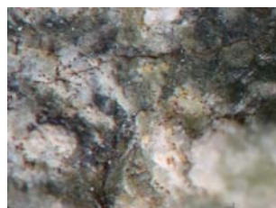
Fig. B341. Nótese la presencia de tonalidades rojizas debido a la meteorización.
