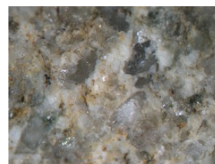
Fig. B305. Nótese la orientación incipiente de los cristales.
