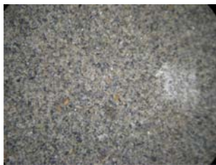
Fig. B119. Nótese los tonos rojizos producto de la meteorización.
