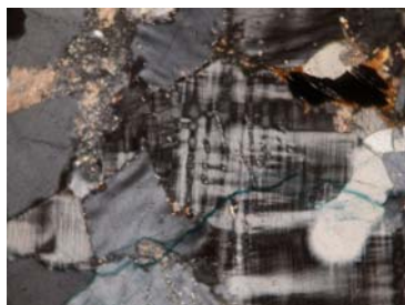
Fig. C385. Presencia de textura perítica en granodiorita.
