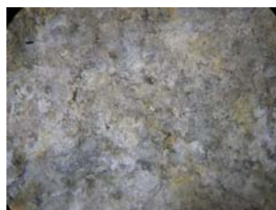
Fig. B388. Presencia de cristales de cuarzo y plagioclase.
