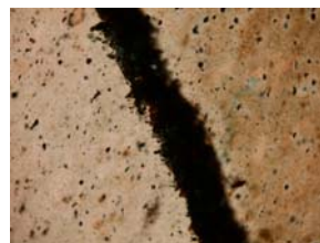
Fig. C147. Detalle de minerales opacos en fracturas (nícoles paralelos).
