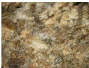
Fig. B164. Nótese los tonos rojizos producto de la meteorización.
