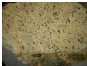
Fig. B161. Obsérvese la presencia de vacuolas rellenas. 0 0,55 cm
