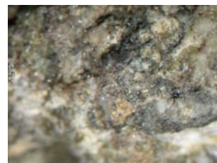
Fig. B339. Cristales de plagioclase altamente meteorizados.
