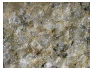
Fig. B179. Obsérvese la presencia de cuarzo y feldespato, principalmente.
