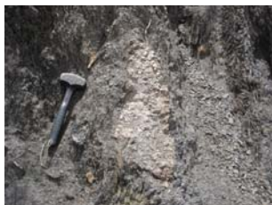
Fig. B49. Bloque granítico altamente meteorizado.
