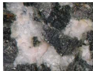
Fig. B386. Nótese las inclusiones de piroxeno dentro de la plagioclasa cálcica.
