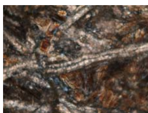
Fig. C364. Alteración en los feldespatos y el ortopiroxeno, a material carbonático y a clorita correspondientemente.
