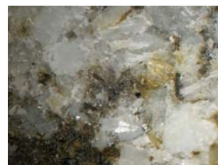
Fig. B210. Obsérvese la presencia de cuarzo y feldespato, principalmente.
