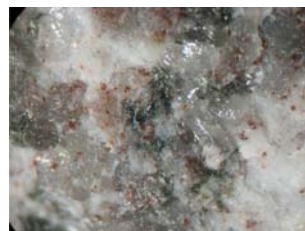
Fig. B45. Obsérvese la presencia de cuarzo, feldespato y micas (biotita).
