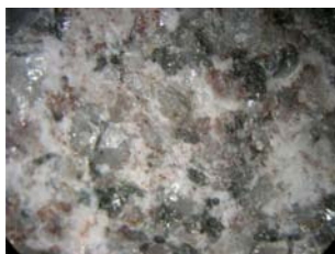
Fig. B44. Tonos rojizos que evidencian los efectos de la meteorización.
