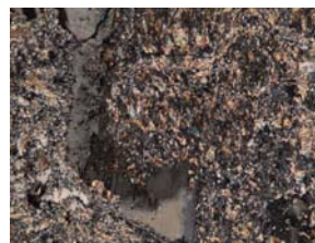
Fig. C26. Plagioclase altamente alterada a material carbonático.
