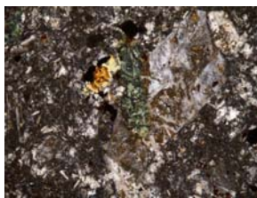
Fig. C142. Fenodacita basáltica porfídica, con alteración de clorita.
