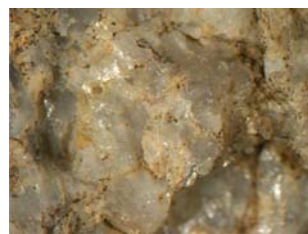
Fig. B77. Se aprecia el contenido de cuarzo, plagioclasea y moscovita principalmente.
