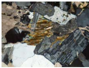
Fig. C154. Cristales de biotita alterando a clorita
