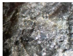
Fig. B182. Obsérvese la coloración gris oscura típica de la Formación La Luna.
