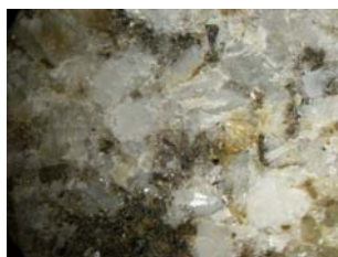
Fig. B209. Nótese los tonos rojizos producto de la meteorización.
