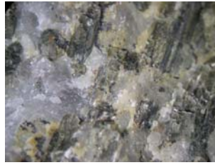
Fig. B343. Obsérvese la presencia de plagioclasa y otros minerales máficos.
