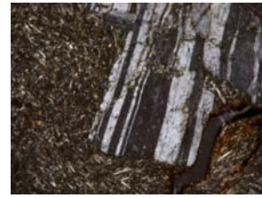
Fig. C211. Fenocristal de andesina cortado por veta de cuarzo policristalino.
