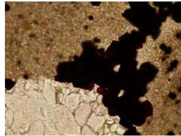
Fig. C18. Fragmento de ostrácodo micritizado y con cemento tipo pseudoespatite.
