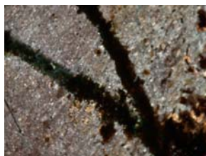
Fig. C146. Obsérvese el fracturamiento relleno por minerales opacos no identificados.
