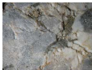
Fig. B82. Se aprecia el contenido de cuarzo, plagioclasa y biotita principalmente.
