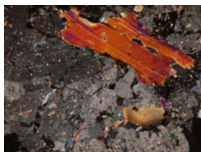
Fig. C398. Obsérvese la albita con alteración a sericita y cristal de biotita titanífera.
