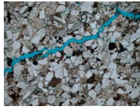
Fig. C303. Porosidad secundaria por fractura (nícoles paralelos).
