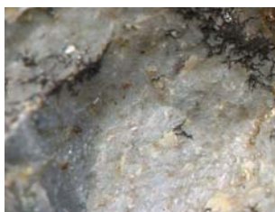
Fig. B299. Obsérvese los colores de meteorización verdosos hacia los bordes y marrón claro a través de las grietas de la muestra.
