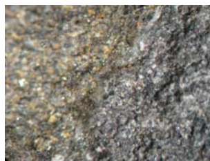
Fig. B313. Nótese los tonos rojizos producto de la meteorización.
