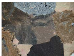
Fig. C279. Cemento de espato, recristalizado y con textura equigranular.
