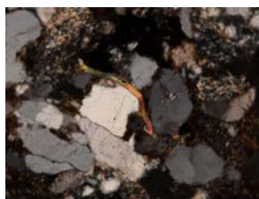
Fig. C68. Biotita altamente deformada.
