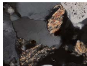
Fig. C3. Alteración de los feldspatos no diferenciados a minerales de arcilla y material carbonático.
