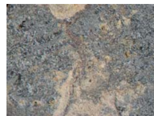
Fig. B102. Obsérvese la coloración rojiza producto de la meteorización de partículas extracrísticas.
