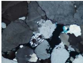
Fig. C258. Granos de cuarzo y fragmento de chert, mostrando contacto suturado y lineal.
