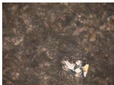
Fig. C389. Basalto altamente alterado.
