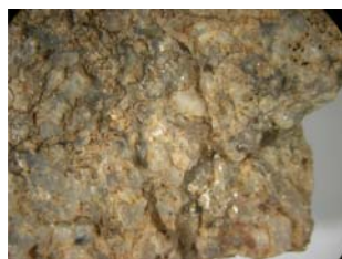
Fig. B76. Obsérvese la tonalidad rojiza por efectos de la meteorización.
