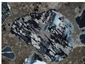
Fig. C278. Extraclasto de feldespato potásico con textura perítica tipo “reemplazo”.
