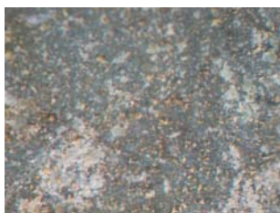
Fig. B169. Nótese los tonos rojizos por efectos de la meteorización.
