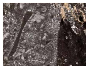
Fig. C116. Contacto de clasto de chert y clasto de lutita.
