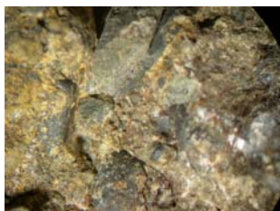
Fig. B297. Obsérvese los tonos rojizos producto de la meteorización.
