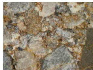
Fig. B116. Nótese la coloración rojiza producto de la meteorización.
