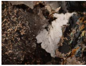
Fig. C59. Nótese la presencia de cuarzo monocristalino, plagioclasea y microclino.
