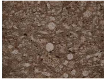
Fig. C320. Nótese la presencia de radiolarios recristalizados (nícoles paralelos).
