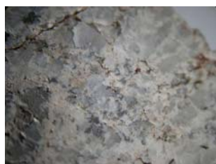
Fig. B99. Obsérvese la presencia de cuarzo y plagioclase, principalmente.
