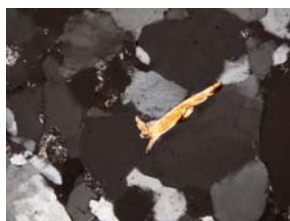
Fig. C2. Grano de biotita levemente deformado y fracturado.
