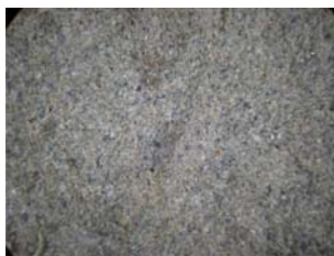
Fig. B125. Nótense los tonos rojizos producto de la meteorización.
