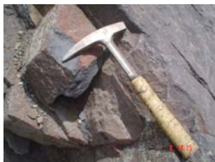
Fig. B57. Nótese la diferencia entre el color meteorizado y fresco de la muestra.
