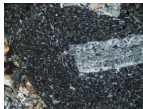
Fig. C167. Clasto de fenoandesita porfídica con textura afieltrada.
