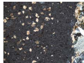
Fig. C168. Clasto de limolita con presencia de cristales carbonáticos.
