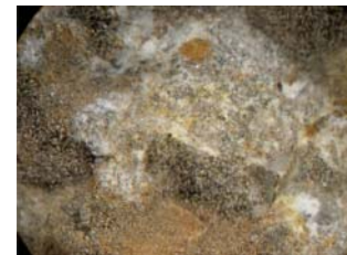
Fig. B23. Obsérvese los colores rojizos producto de meteorización.
