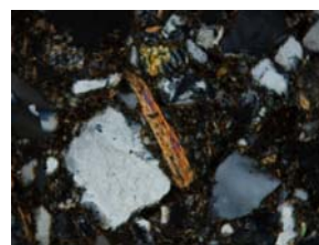
Fig. C283. Grano de biotita evidenciando el bajo grado de deformación.
