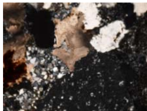
Fig. C10. Presencia de chert, cuarzo policristalino plutónico, cuarzo monocristalino y alta alteración a calcita.
