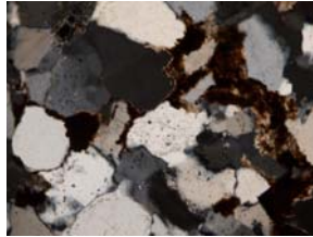
Fig. C8. Presencia de óxidos de hierro como cemento alrededor de minerales opacos.
