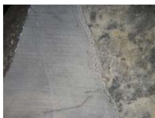
Fig. B47. Obsérvese el halo de recristalización en el contacto.
