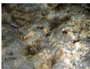
Fig. B242. Nótese los tonos rojizos producto de la meteorización.
