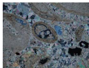
Fig. C40. Obsérvese el Cemento tipo pseudoespato y la presencia de fragmentos de foraminíferos bénticos.
