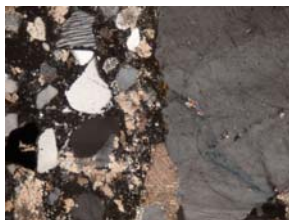
Fig. C382. Zona de contacto entre granodiorita y conglomerado.
