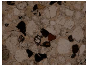
Fig. C125. Presencia de hematita, pirita e ilmenita.
