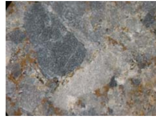
Fig. B28. Obsérvese el contacto tangencial entre granos de cuarzo.
