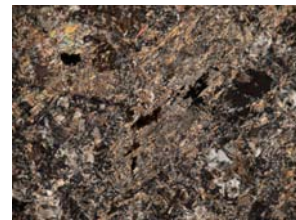
Fig. C65. Plagioclasea (oligoclasea, 25% An), altamente alterada a material carbonático.
