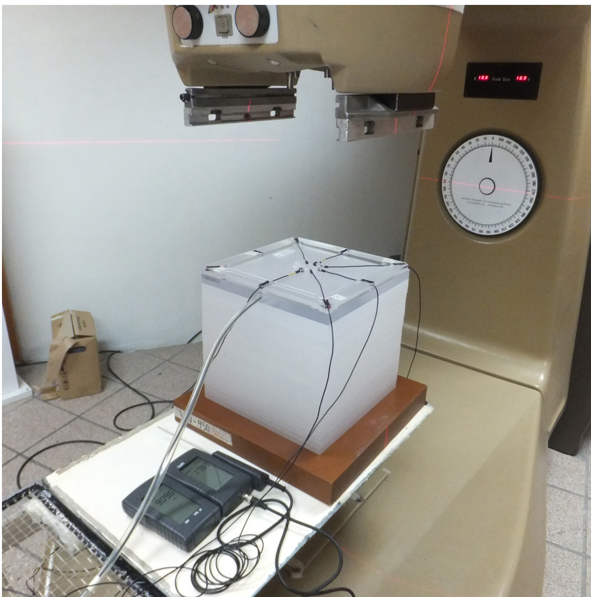
Figura A.3: Montaje experimental para la obtención de las medidas para la calibración de los diodos.
