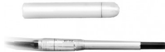
Figura 3.9: Cámara de ionización IBA Scanditronix FC65-G. Fuente: https://goo.gl/hy4VaB
