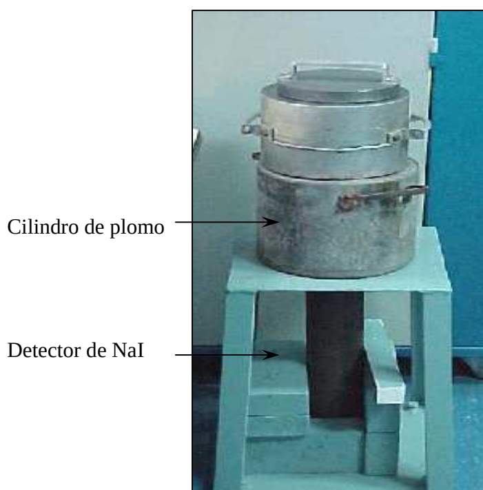
Figura A21. Foto del Espectrómetro de rayos Gamma multicanal utilizado en el presente trabajo, donde se muestra la ubicación del cilindro de plomo y el detector de NaI.
