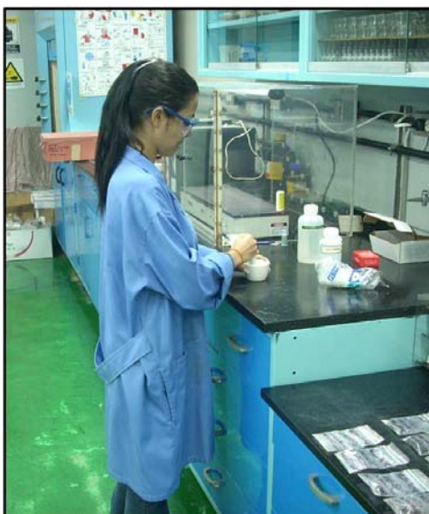
Figura 3. Trituración de muestra para análisis de nanoplancton calcáreo.
