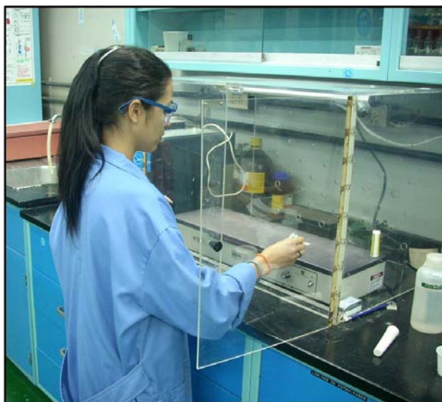
Figura 4. Colocación de muestra en el cubre objeto para análisis de nanoplancton calcáreo.
